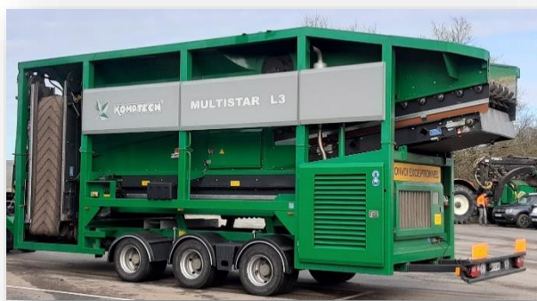
Photo du Crible Biomasse Valdéfis Crible à étoiles: Tri des matières en 3 fractions
